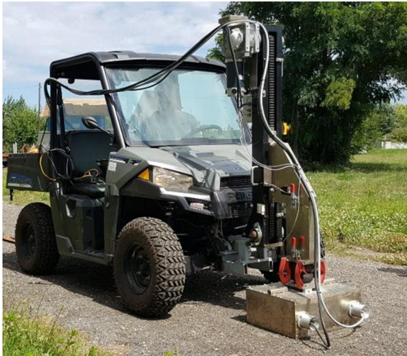
Nehezen megközelíthető helyeken alkalmazott vibroszeiz jelforrás
